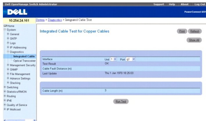
Abbildung 6-32. Integrierter Kabeltest für Kupferkabel
