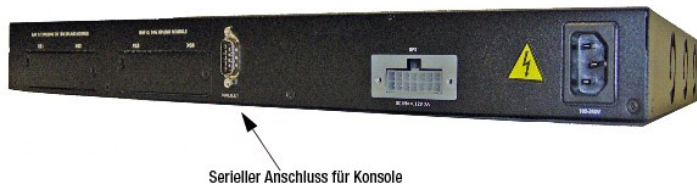
Abbildung 4-5. Serielle Verbindung zu Switch
